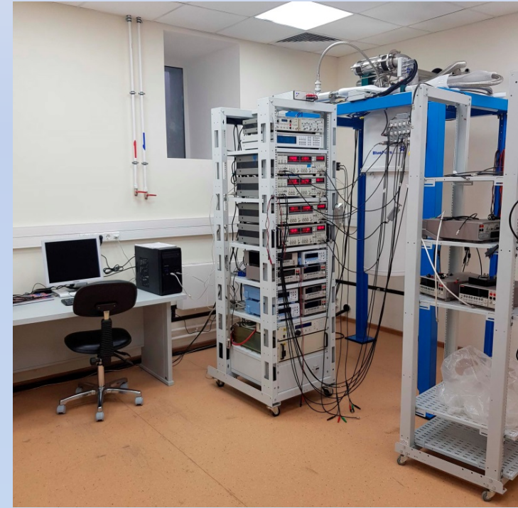
Установка BF-250LD (температура 10мК)
