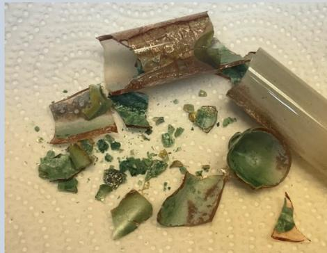
1. Примесь  $\text{Cu}_2\text{S}$  в матрице апатита вызывает резкое падение сопротивления всего образца вследствие структурного перехода при  $T \sim 110^\circ\text{C}$ . Образец остается изолятором при  $T > T_c$  и  $T < T_c$
