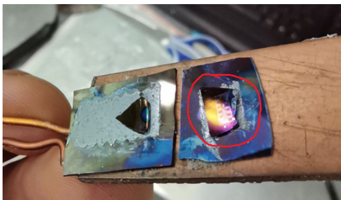
Рис. 2.3. (в цвете). Фотография образца после изготовления структуры и нанесения подзатворного диэлектрика. Образец теллурида ртути обведён красным цветом; он приклеен двусторонним скотчем к кремниевой подложке для удобства обращения с образцом. Размер изображённой на рисунке структуры порядка пяти миллиметров, толщина всей пластины теллурида ртути порядка миллиметра.
