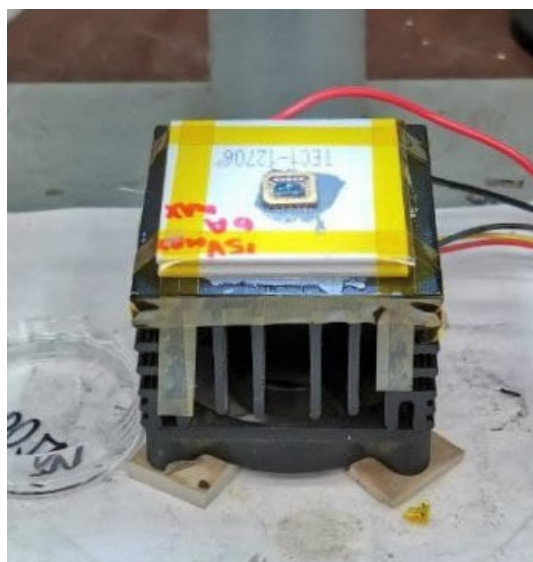
Рис. 4.14. (в цвете). Система охлаждения образца для припаивания индиевых контактов. Элемент Пельтье находится на радиаторе, охлаждаемом вентилятором. Образец, смонтированный на держатель измерительной установки, на холодной стороне Пельтье. Все элементы соединены термопастой.
