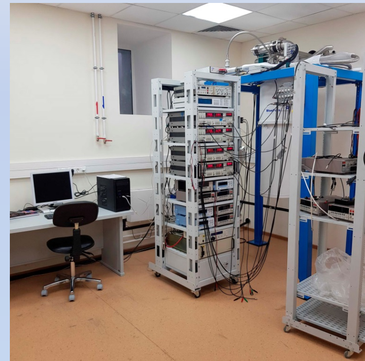
Установка BF-250LD (температура 10мК)
