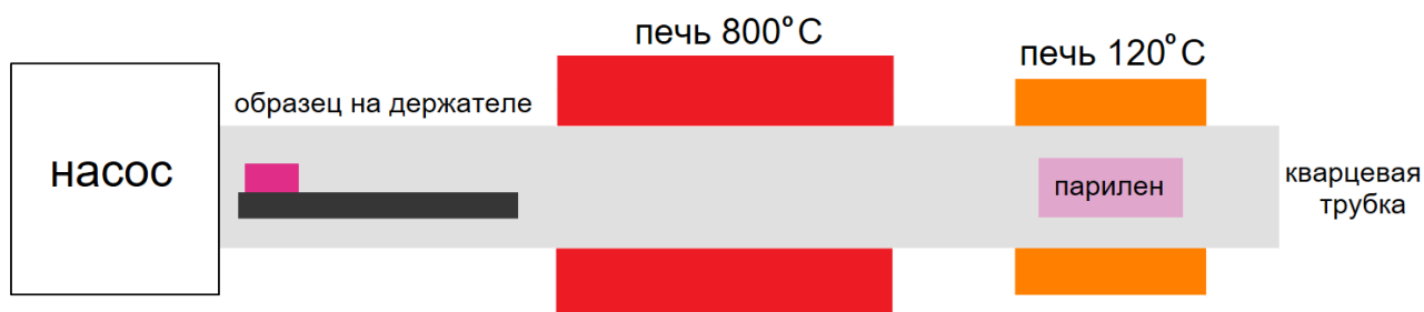
Рис. 4.7. (в цвете) Схема установки напыления парилена
