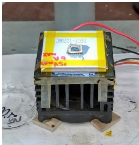
Рис. 4.14. (в цвете) Система охлаждения образца для припаивания индиевых контактов.
