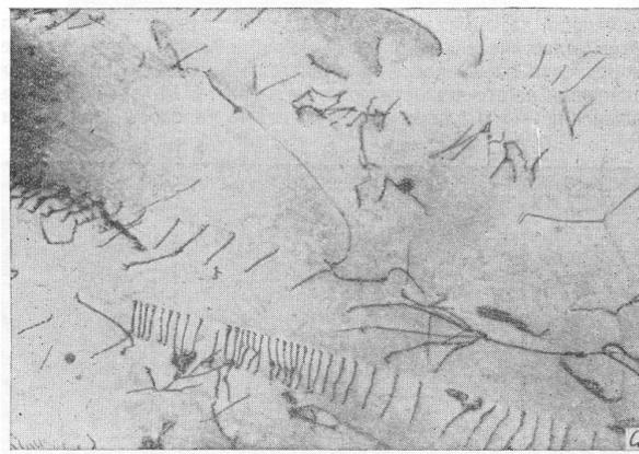
Рис. 8.17: Дислокации в тонкой фольге из сплава меди с 4% Al. Снято в растровом электронном микроскопе с увеличением 30,000 $\times$
