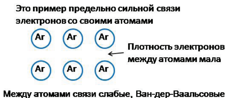
Рис. 3.16: Схематическое изображение упаковки атомов в кристалле Ar с Ван-дер-Ваальсовым типом связи
