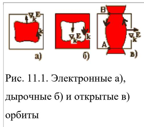
Рис. 11.1. Электронные а), дырочные б) и открытые в) орбиты
