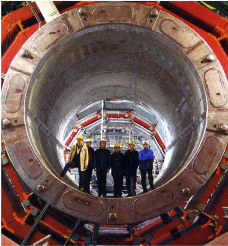
Рис. 7. Суперпроводящий соленоид (весом 224 т, включая около 15 т Nb-Ti суперпроводящего кабеля) для детекторов частиц Большого адронного коллайдера
