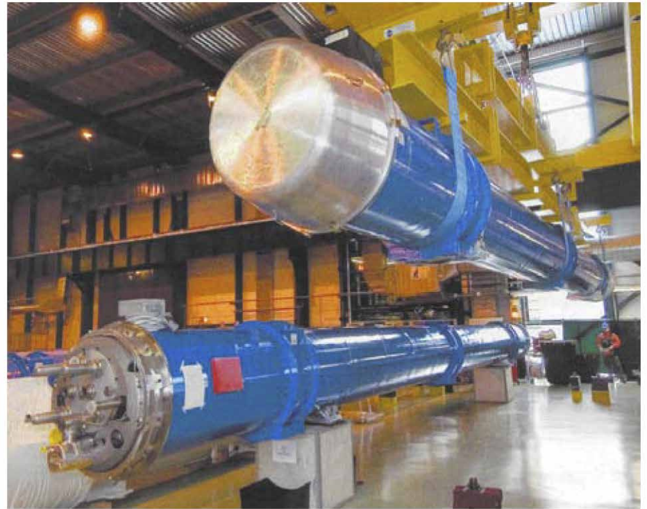
Рис. 6. Два из 1232 суперпроводящих дипольных магнита (длиной по 15 м и весом 35 т каждый) для Большого адронного коллайдера ЦЕРН
